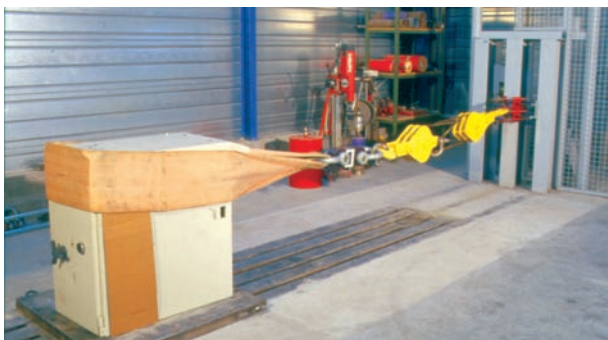
La procédure de contrôle du CNPP passe par des essais de laboratoire. Ci-dessus, essai de résistance de coffre-fort.
